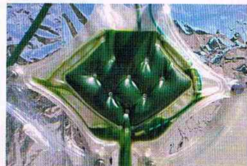
COLTIVAZIONI. Reattore per la coltura d'alghie ( Chlorella ) su pareti verticali: sarà usato all'Expo di Milano.
